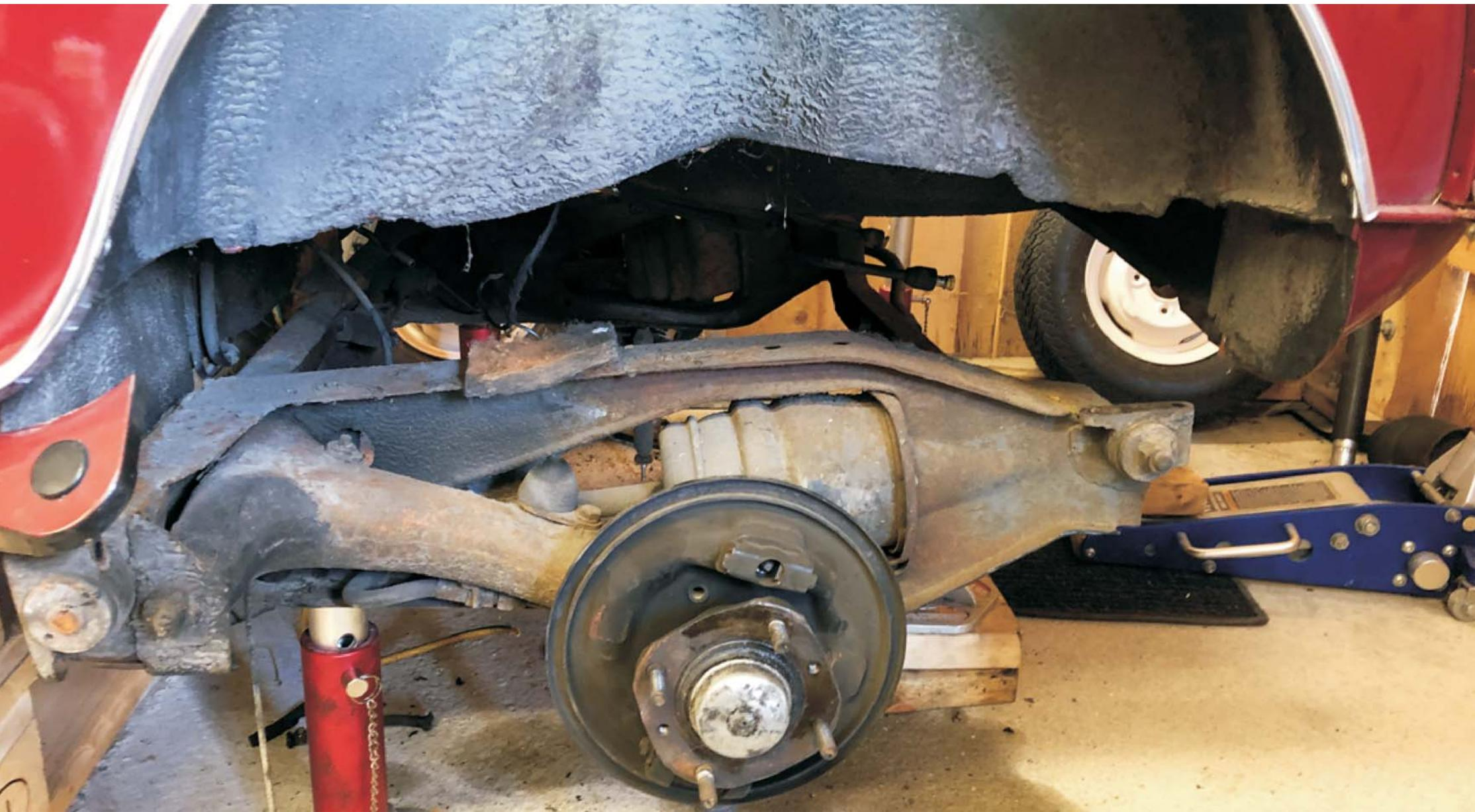
Der Wagen wurde komplett zerlegt und die Flex fand ihren Einsatz, um den Pfusch vorheriger Sanierungsversuche am Lochfraß zu beseitigen. Von diesen Versuchen zeugten Silikon und Popnieten. Man merkte schnell, dass der Wagen von innen nach außen durchgerostet war. Diese Tatsache war schade, da man die Durchrostungen hätten verhindern können.
