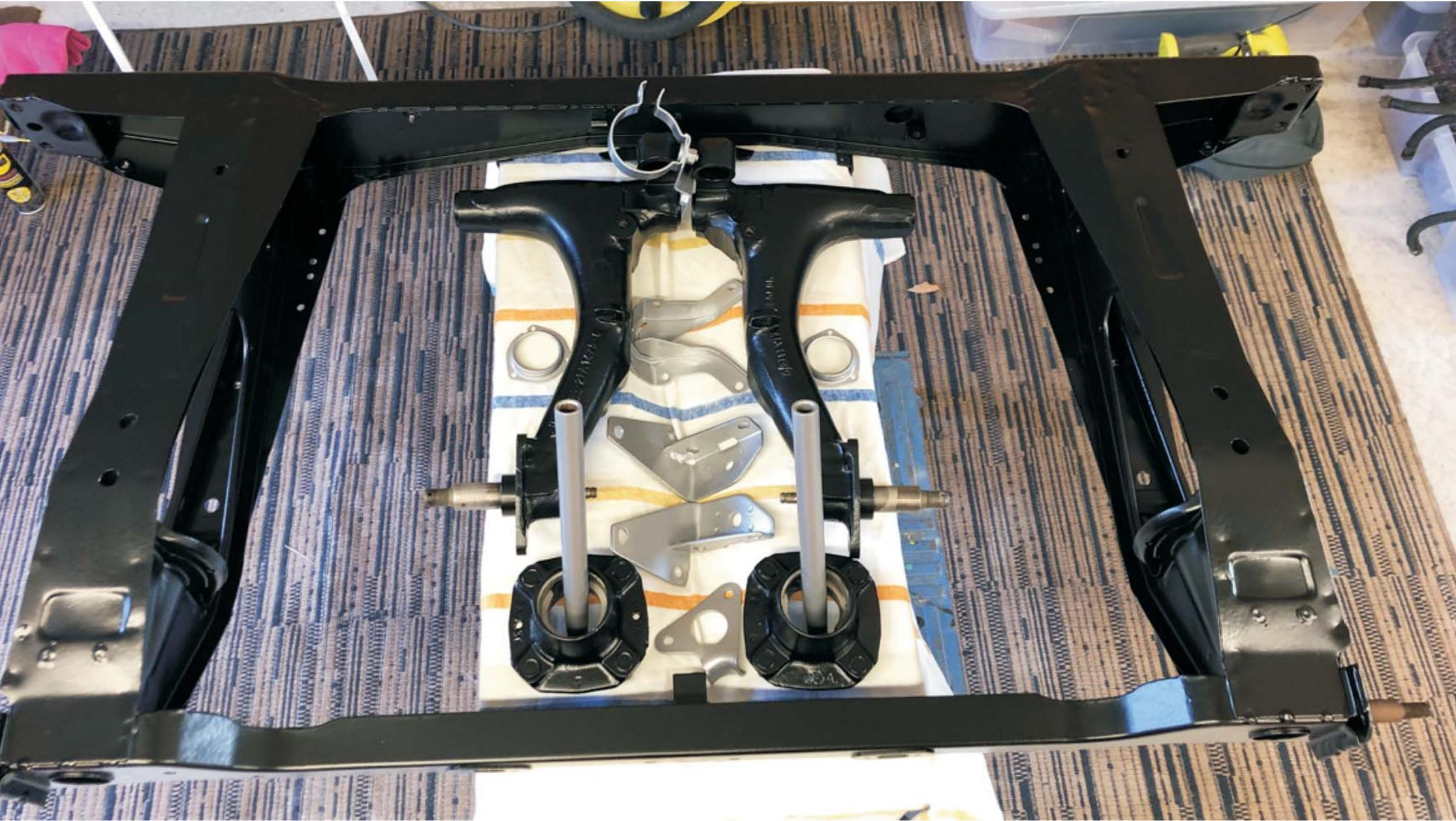
Der hintere Hilfsrahmen, gestrahlt mit den Achsschwingen
