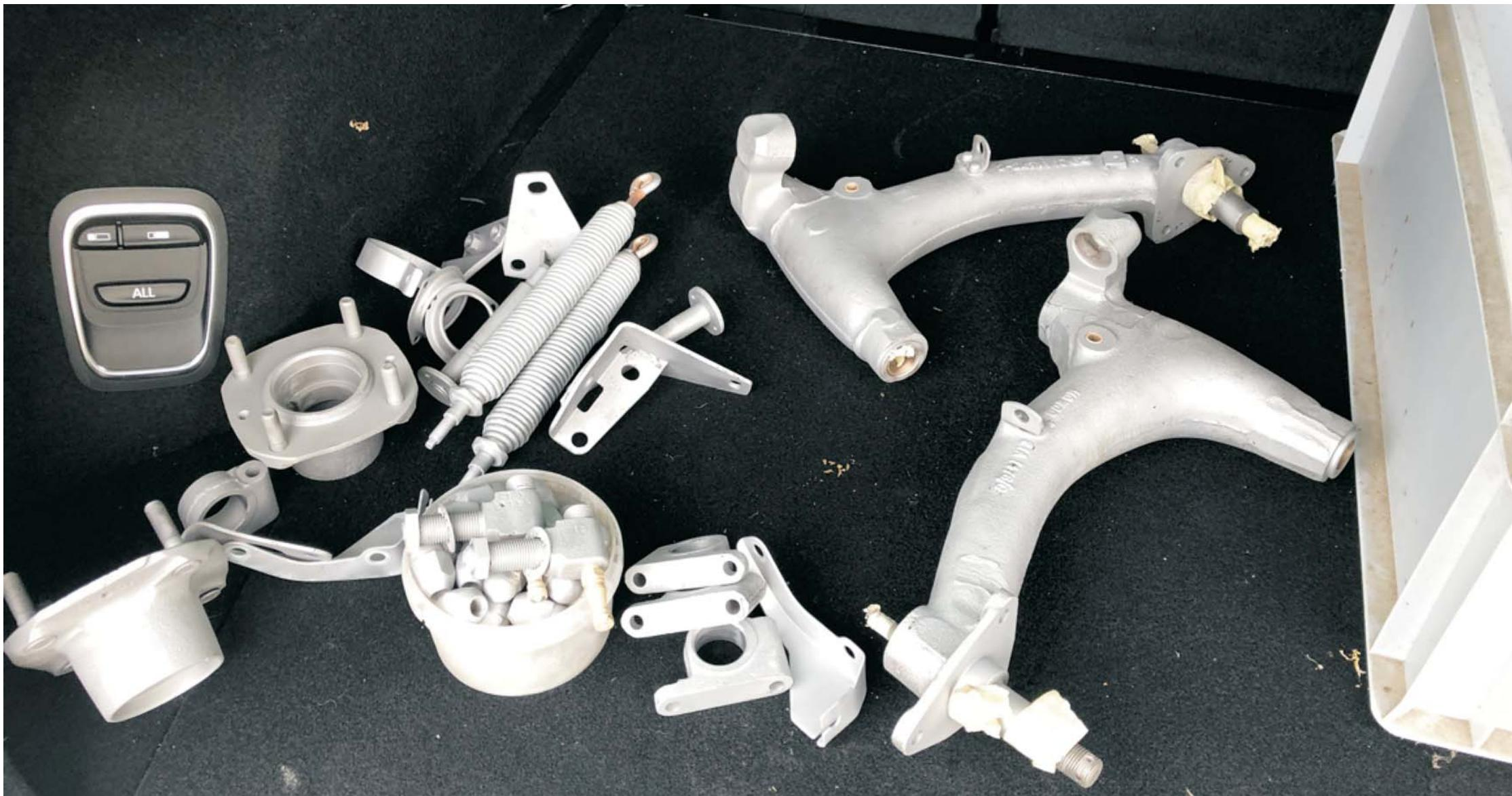
In der zwischen Zeit zerlegte ich den Rest, strahlte alle Schrauben und übrigen Teile. Die Schrauben und Halter wurden dann galvanisch weiß verzinkt und alle anderen Teile wurde Epoxy grundiert und zweimal pulverbeschichtet.
